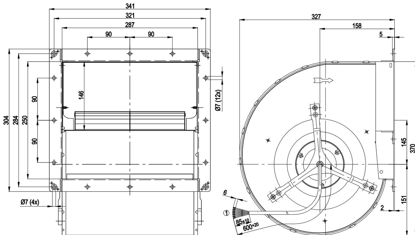
1 Соединительный провод AWG20, с заделкой 7 зажимами
