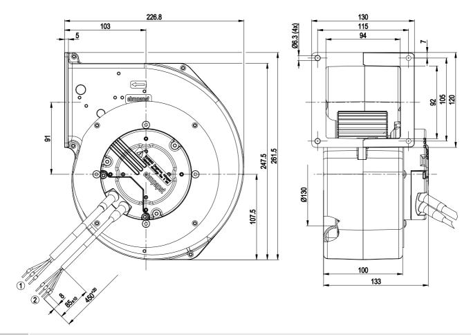
1 Соединительный провод, ПВХ, AWG 22, с заделкой 4 втулками
